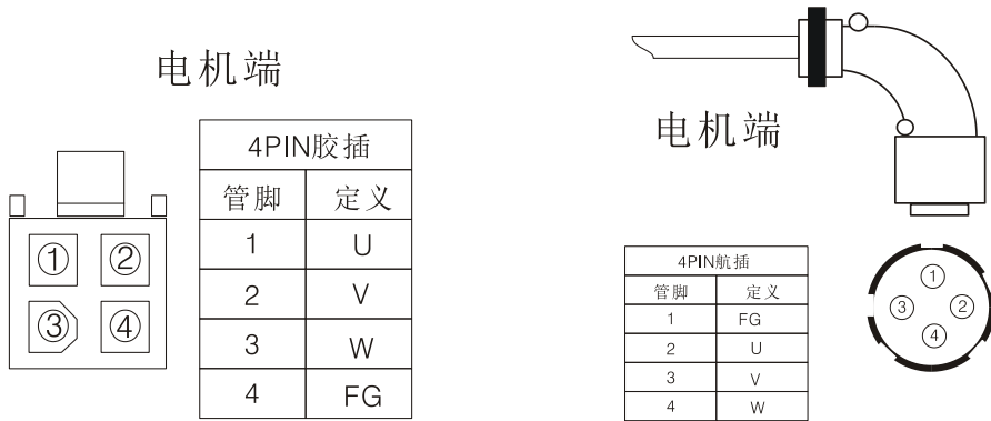
图 3.2 电机电源接线端
